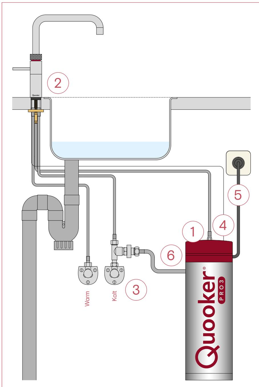
7. Stellen Sie nun das neue Reservoir in den Schrank. Schließen Sie den Zulaufschlauch des Reservoirs mit der beiliegenden Dichtung an das T-Stück an.
